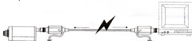
**RE-PR2 - Protezione ingresso video RJ45 su doppino twistato e cavi CAT5.** Il modulo di protezione RE-PR2 possiede le stesse caratteristiche di protezione del modello RE-PR1, ma è sviluppato per proteggere le trasmissioni video su cavo twistato che si effettua utilizzando gli appositi convertitori balun. E' possibile utilizzare il modulo RE-PR2 sia con i convertitori balun passivi RE-BNCRJ1 che attivi.
