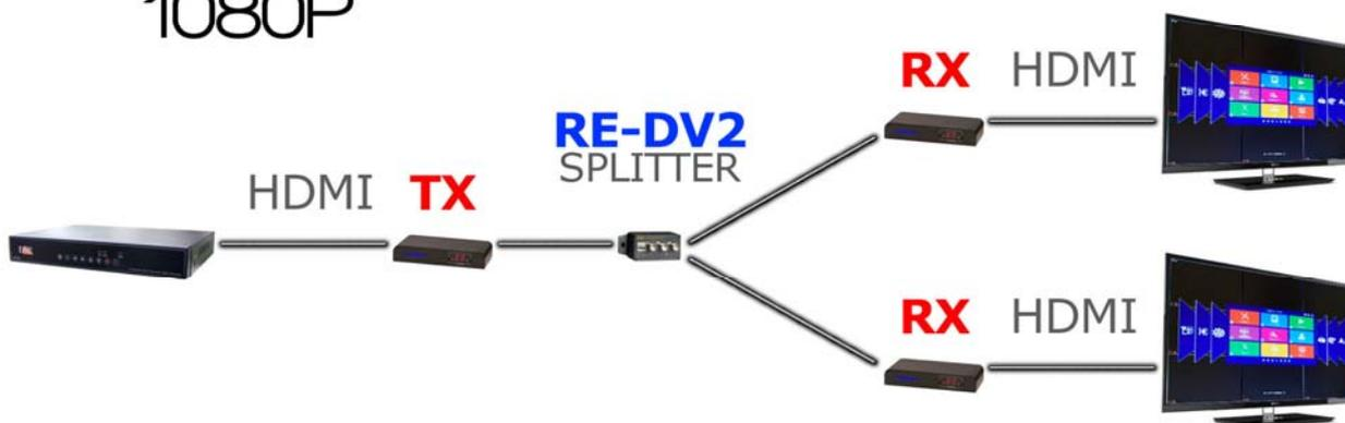
Se si utilizzano splitter bidirezionali, come quelli utilizzati nella TV via cavo, è possibile anche utilizzare il trasporto di più trasmettitori su un solo cavo coassiale posto fra due splitter. In questo modo sul cavo coassiale passeranno più segnali HDMI ognuno distinguibile con una propria frequenza.
