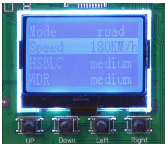
**MODE** – La prima voce del menu ti permette di autoconfigurare tutte le opzioni successive in modo rapido semplicemente selezionando il tipo di impiego della telecamera. Seleziona PARKING se stai usando la telecamera in una zona in cui i mezzi si spostano lentamente, come in un parcheggio o in un'area di servizio. Seleziona ROAD se vuoi monitorare una strada con mezzi in movimento veloce.
