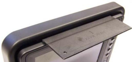
Nel monitor ML-7 invece bisogna rimuovere i due adesivi, se presenti, ai lati della base di fissaggio che coprono quattro viti. Svitando le viti è possibile smontare i due supporti ed estrarre il monitor dalla sua base di fissaggio. Tra gli accessori possiamo trovare una coppia di adesivi utilizzabili per coprire le viti una volta che il monitor è stato montato.
