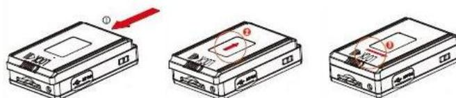
**Inserimento SD card** – Prima di accendere il DVR, la prima cosa da fare è installare la SD card. Senza SD card il DVR non si avvia.
