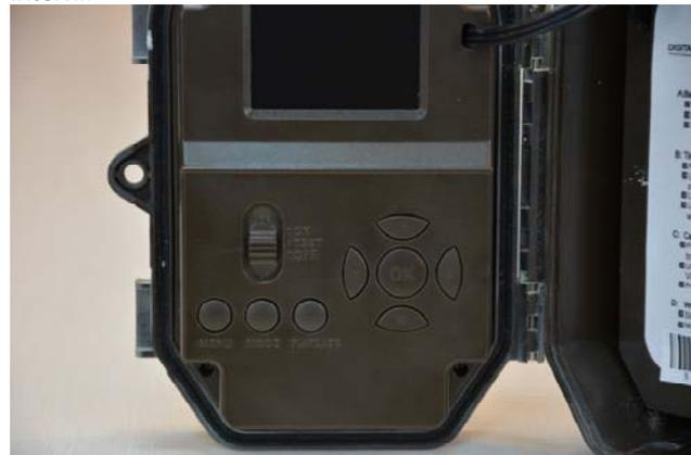
Come prima cosa, per avviare l'apparecchio e configurarne le opzioni, occorre **spostare il selettore generale in posizione TEST**, in questo modo l'apparecchiatura si avvia.
