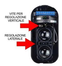
Come prima cosa occorre fare un allineamento ottico agendo sia sul ricevitore che sul trasmettitore per poi procedere con l'affinamento come spiegato di seguito. Per allineare perfettamente la barriera bisogna osservare il livello di segnale indicato dal display. Verificare che gli **interruttori 7 e 8** siano entrambi su ON per poter vedere sul display il livello del segnale IR.
