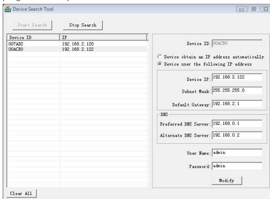
2. Fare clic sul pulsante START SEARCH. Il programma inizierà a ricercare le telecamere IP serie RH presenti in rete. Attendere il completamento della ricerca. IP search è in grado di rilevare anche telecamere con classe di indirizzo diversa da quella del PC su cui si sta operando.
