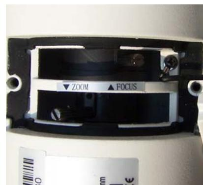
E' anche presente un'uscita video analogica locale con connettore RCA posto dietro lo sportellino stagno nero sul lato inferiore della telecamera (vedere in seguito). Questa uscita può servire per collegare un monitor localmente e poter regolare l'obiettivo nella posizione reale di funzionamento della telecamera.
