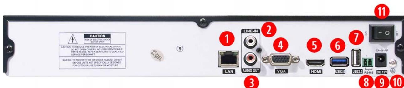
1 – PORTA DI RETE – Connettore RJ45 per collegare l’NVR a una rete LAN 10M/100M. Prima di utilizzare la connessione LAN impostare i parametri di rete nel menu di configurazione del videoregistratore. Negli NVR la connessione di rete è fondamentale perchè è la sola porta di comunicazione verso i dispositivi dell’impianto. Verificate che i LED giallo e verde si accendano entrambi una volta collegato l’NVR allo switch.
