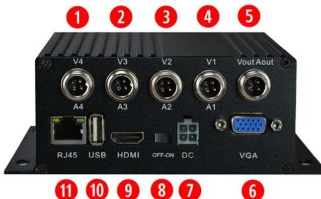
1-2-3-4 – INGRESSI VIDEO – Connettori video per collegare le telecamere AHD 720P o analogiche CVBS. Gli stessi ingressi si usano per le due tipologie di segnale. Il DVR riconosce automaticamente la tipologia di ingresso AHD o CVBS (analogico). Attenzione: questi DVR non supportano risoluzione superiori a 720P.
