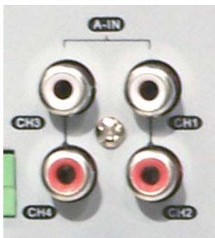
AUDIO IN – Ingressi audio mono per collegare dei microfoni esterni oppure il segnale audio proveniente da telecamere con audio incorporato. Il connettore utilizzato è RCA. Utilizzando microfoni esterni è necessario che essi dispongano di propria alimentazione.
