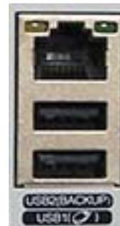
6 – PORTE USB – I DVR sono muniti di 2 porte USB. Alle porte USB si collegano il mouse in dotazione, e unità di archiviazione USB come chiavette USB o HDD USB per il backup dei filmati. Non vi sono differenze fra le due porte.
