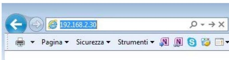
Non è necessario precisare la porta di collegamento in quanto i DVR serie DX utilizzando di fabbrica la porta 80 che è quella utilizzata normalmente dai browser
