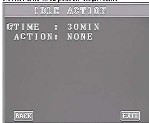
E' possibile impostare un tempo di inattività (TIME) con le seguenti opzioni: 30 sec./ 1 min./ 5 min./ 10 min./ 30 min. e l'azione da compiere (ACTION). E' possibile scegliere di richiamare il preset 1, lo scan 1, il sequence 1 o il pattern 1
