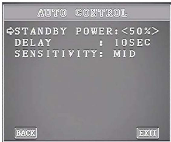
Si possono impostare la riduzione di potenza dei LED (da 10 a 90%), il tempo da attendere in assenza di movimento per ritornare in stand-by (in secondi) e la sensibilità della rilevazione.
