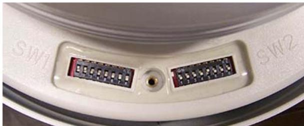
Il primo blocco di 8 microswitch a sinistra SW1 serve a impostare l'indirizzo ID della telecamera che la contraddistingue sul BUS (da 1 a 255), mentre il secondo blocco serve a definire la velocità di trasmissione. Solo i microinterruttori 4 e 5 sono utilizzati in questo caso.
