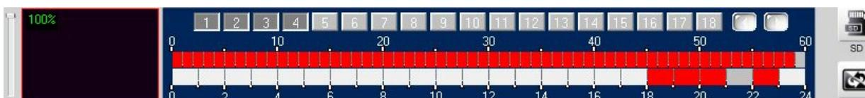
Essa si compone di 2 righe numerate. Quella inferiore è numerata da 0 a 24 e rappresenta le ore, quella superiore da 0 a 60 e rappresenta i minuti. La timeline assume diversi colori a seconda dei dati contenuto nel database.
