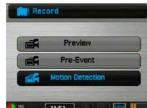
Il DVR si porta in uno stato di attesa registrazione e vi richiede di premere il pulsante REC per iniziare a registrare. Se in questa situazione premete il tasto SETUP potete impostare le opzioni di registrazione in Motion dell'apparecchio. I primi parametri sono analoghi alla registrazione continua (vedi sopra). In aggiunta si devono impostare:
