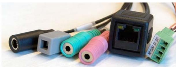
○ **Collegamento alla rete LAN** – La prima cosa da fare è collegare il video server alla rete LAN. A tale scopo sul retro di tutte le telecamere IP è presente un connettore RJ45. In genere ci si collega a un HUB o SWITCH della rete utilizzando un cavo di rete dritto.
