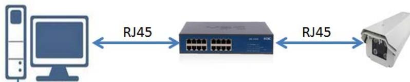
Appena collegata rete e alimentazione controlla che i Led della porta dello switch inizino a lampeggiare. Questo significa che la telecamera sta funzionando e puoi proseguire nella configurazione dell'indirizzo IP.
