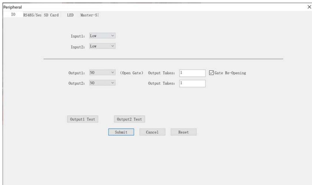
INPUT 1 (RILEVATORE VEICOLI)– Imposta il funzionamento dell’ingresso 1 nella morsettiera della telecamera che si può usare per collegare un rilevatore di veicoli nella carreggiata (ingresso digitale Low/High)
