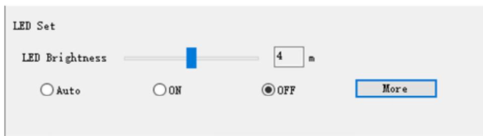
AUTO – L'illuminatore si accende automaticamente in base al sensore di luminosità posteriore
