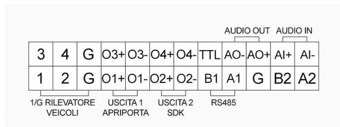
AO-/+ AUDIO OUT – Si può collegare un altoparlante per il dialogo bidirezionale che si può utilizzare tramite SDK
