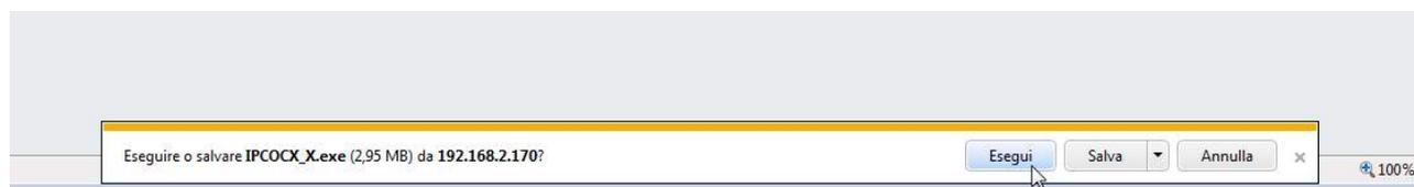
E' possibile sia eseguire il programma direttamente scegliendo ESEGUI che salvare il file sul PC locale ed installarlo poi manualmente. Occorre chiudere il browser per installare il plugin. Una volta installato il programma occorrerà riavviare il browser ed effettuare nuovamente il collegamento verso la telecamera.
